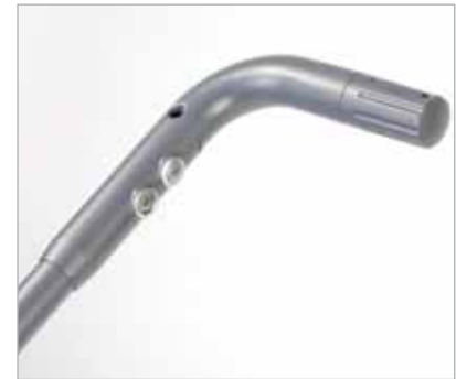
Bediengriff mit stufenlosem Gasgriff für Vorwärtsfunktion sowie Taster für Freilauf und Distanzgeber für 10, 20, 30 Meter.
