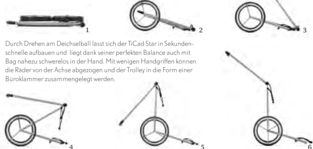
Durch Drehen am Deichselball lässt sich der TiCad Star in Sekundenschnelle aufbauen und liegt dank seiner perfekten Balance auch mit Bag nahezu schwerelos in der Hand. Mit wenigen Handgriffen können die Räder von der Achse abgezogen und der Trolley in die Form einer Büroklammer zusammengelegt werden.
